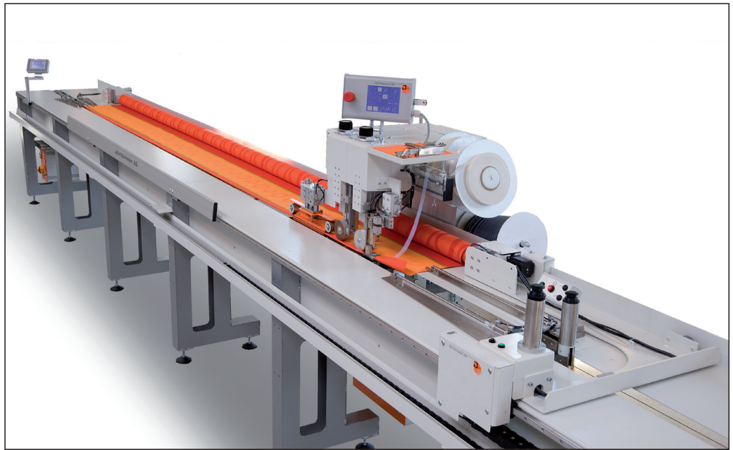
Das Unternehmen hat eine ausgeklügelte Ultraschallschweißmaschine entwickelt, die mit zwei Ultraschall Schweißköpfen arbeitet.
